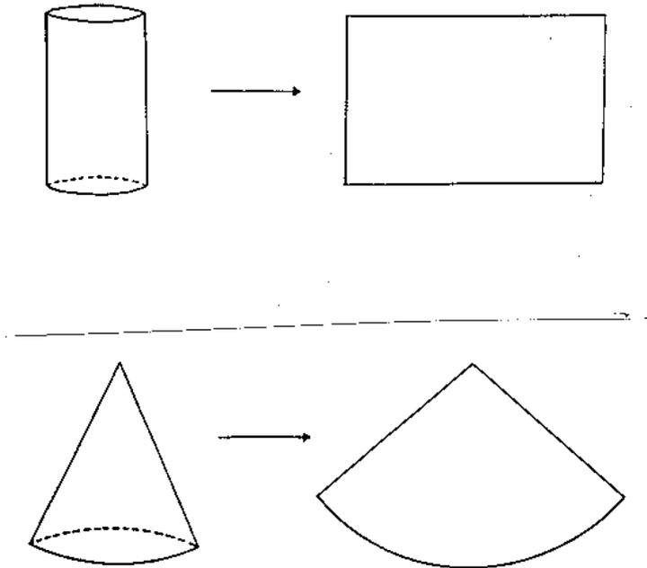
Figura .2.5 - Superfícies de Projeção desenvolvidas em um plano.
