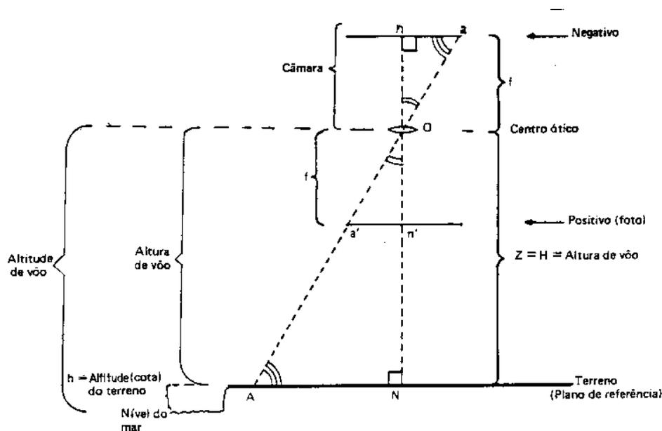
Figura 4.1. - Geometria básica de uma fotografia aérea
