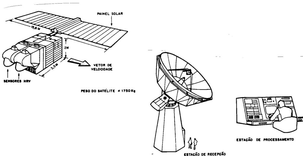
Figura 2.23 - Componentes do Sistema SPOT
