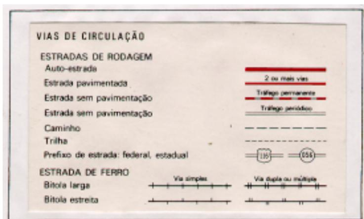
Figura 3.7 - Vias de Circulação (Carta topográfica esc. 1:100.000)
