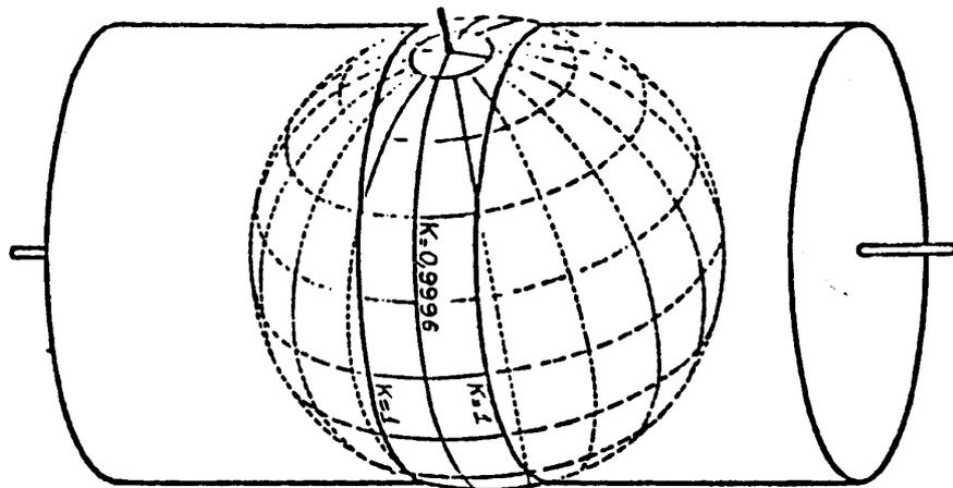
Figura 2.10 - Cilindro secante
