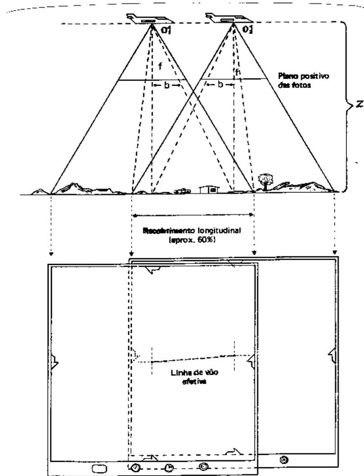
fig. 4.3 - Recobrimento longitudinal
