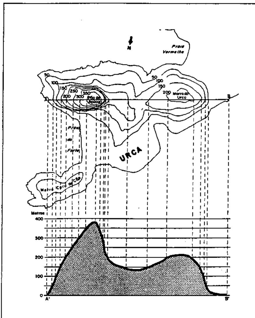
Figura 3.18 - Perfil topográfico
