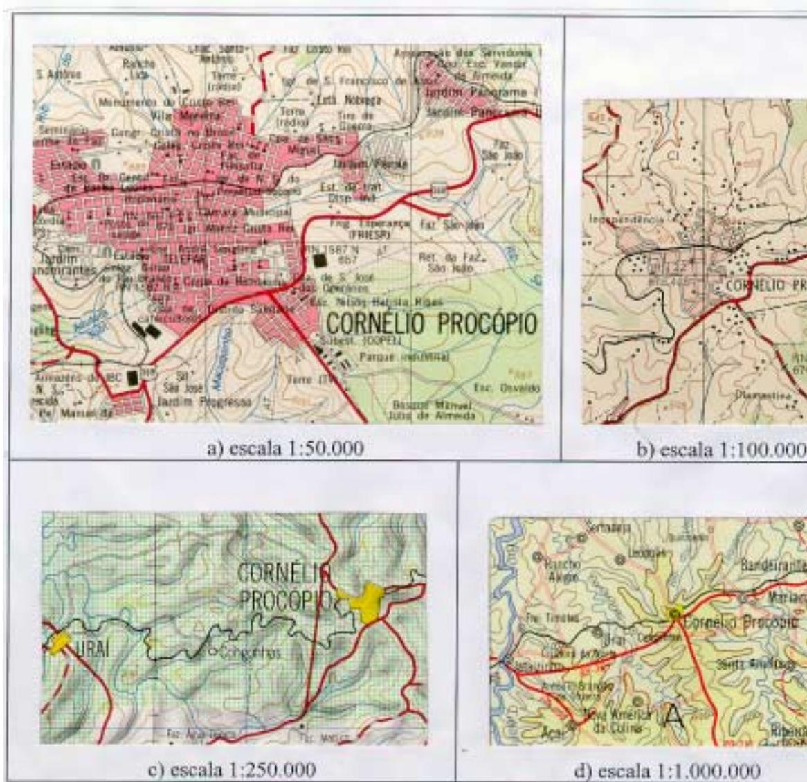
Figura 3.6 (a, b, c, d) - Uma mesma localidade representada em várias escalas
