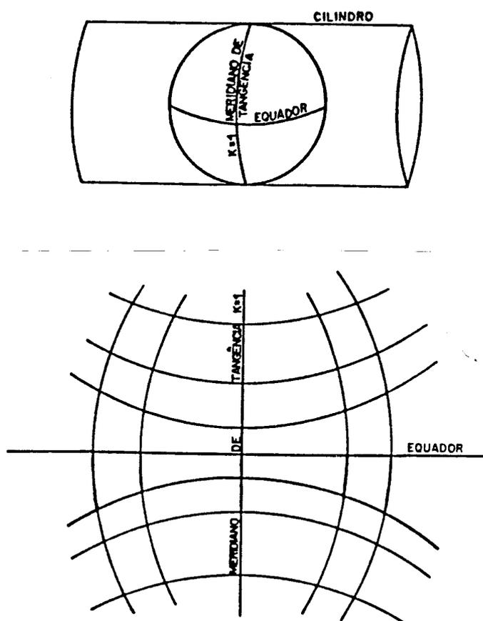
Figura 2.9 - Projeção Cilíndrica Transversa de Mercator
