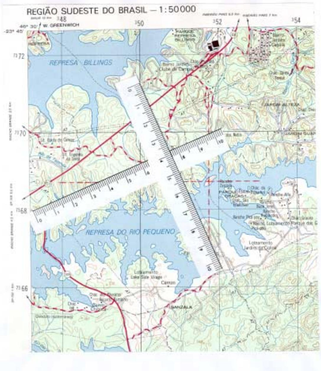
Figura 5.2 - Marcação do ponto A através das suas coordenadas UTM.
