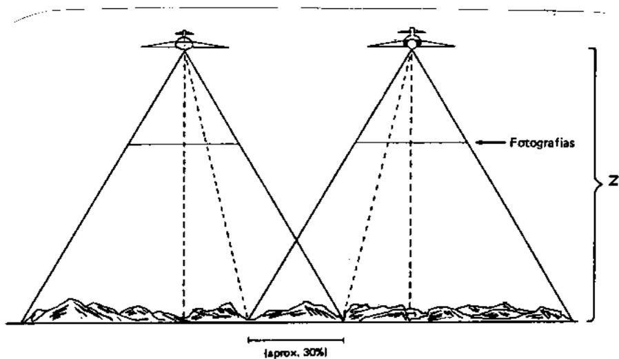
Figura 4.4 - Recobrimento lateral
