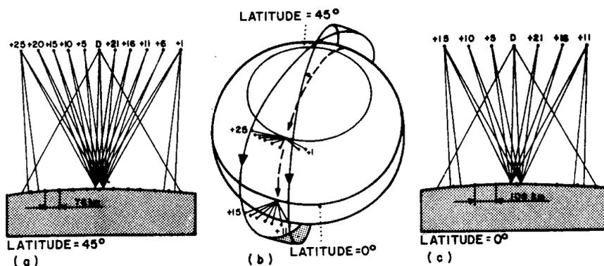
Figura 2.22 - Aquisição de dados proporcionado pela visada “off-nadir”
