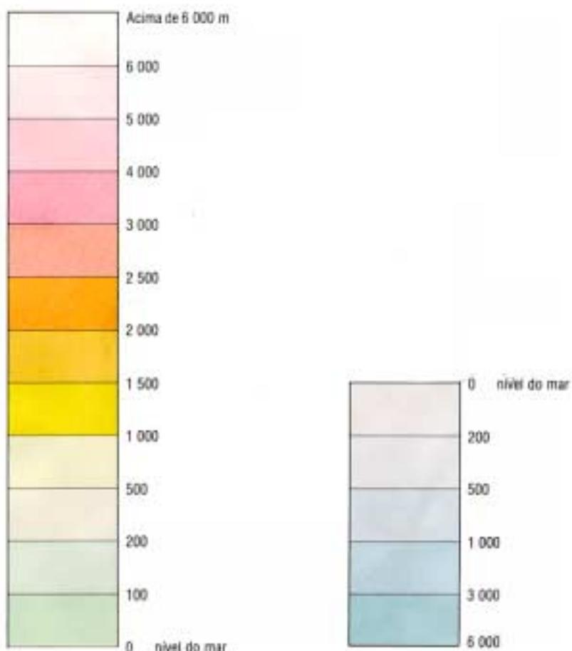
Figura 3.10 - Escala de cores Hipsométrica e Batimétrica (CIM)
