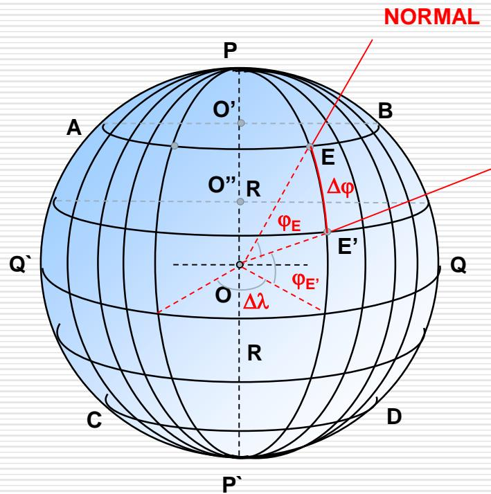
**Comprimento do arco de meridiano** entre os pontos EE', sendo o raio da esfera igual a (R) e a diferença de latitude entre os pontos  $\Delta\varphi$ .
