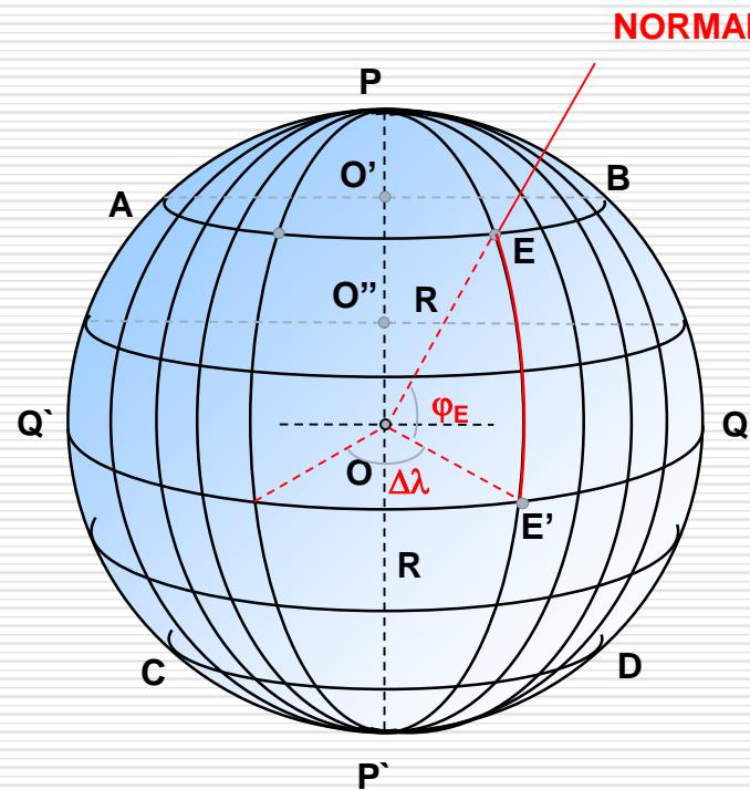
**Comprimento do arco de meridiano** entre o ponto E e o equador, sendo o raio da esfera igual a (R) e a latitude do ponto E igual a  $\phi$ .
