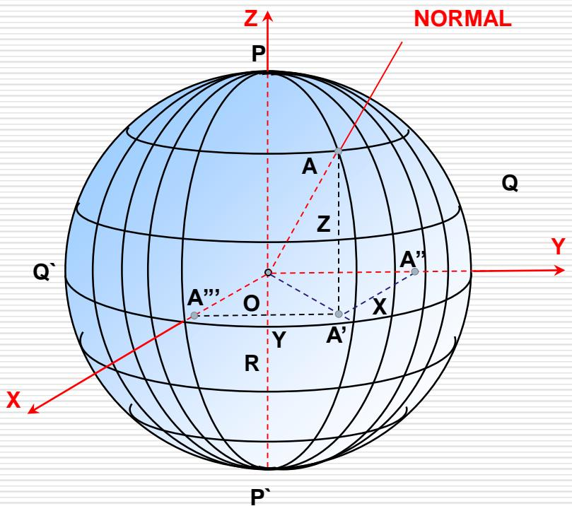
O sistema de coordenadas cartesiano triortogonal, com o eixo Z coincidente com o diâmetro de rotação da esfera e os eixos X e Y jacentes no plano do equador, permite enunciar a posição do ponto genérico A como sendo dada pelo terno de números reais:
