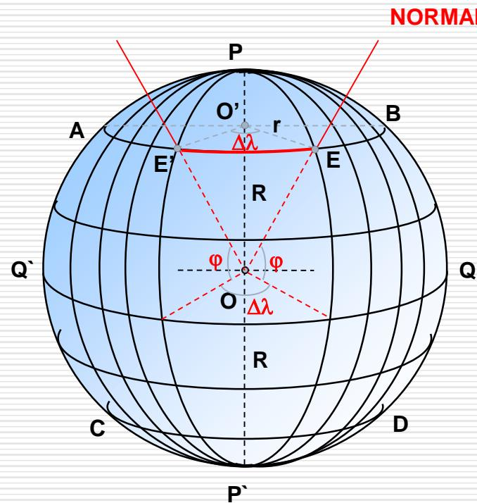
**Comprimento do arco de paralelo** entre os pontos EE', sendo o raio do paralelo de latitude igual a ( $r$ ) e a diferença de longitude entre os pontos  $\Delta\lambda$ .
