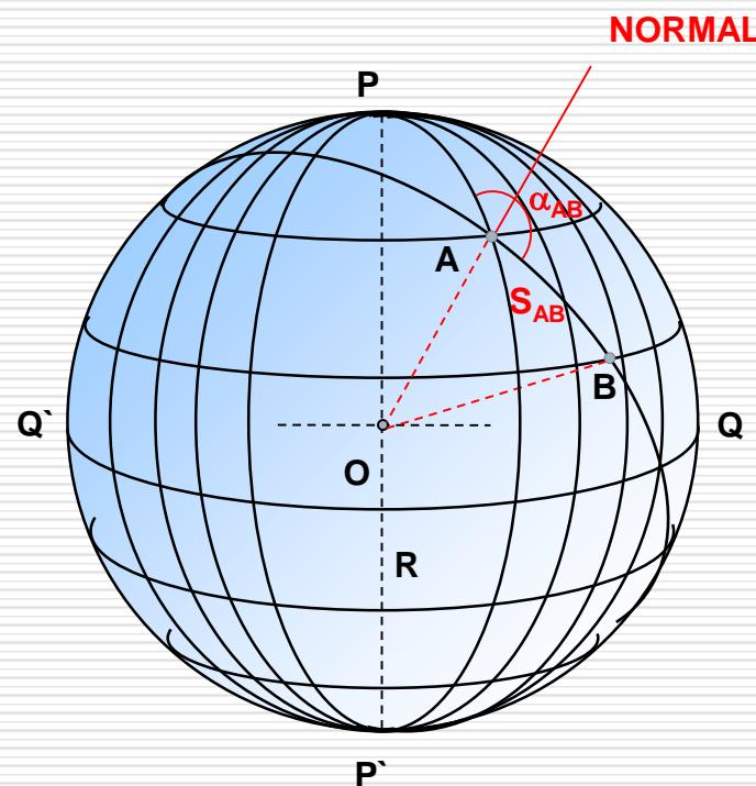
**Azimute Esférico** – ângulo entre o arco de meridiano do ponto A e o arco de círculo máximo que demanda ao ponto B.
