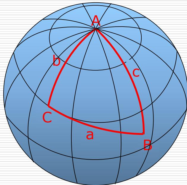
**Resolver o triângulo esférico significa tornar conhecidos os seis parâmetros definidores do triângulo (os três lados e os três ângulos).**
